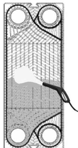
**Рисунок В.3 – Схема очистки теплообменника водой под давлением**
