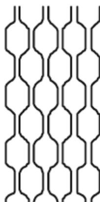
**Рисунок В.5 – Вид пакета пластин при правильной сборке**
