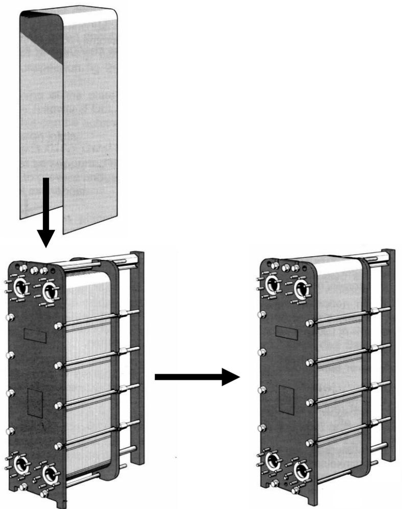
**Рисунок А.5 – Схема установки защитного экрана**
