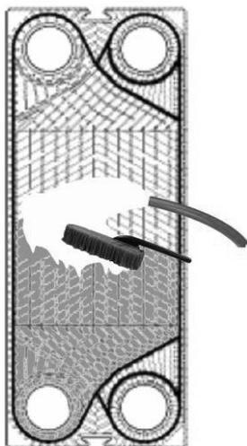
**Рисунок В.2 – Схема очистки теплообменника моющей жидкостью и щеткой**
